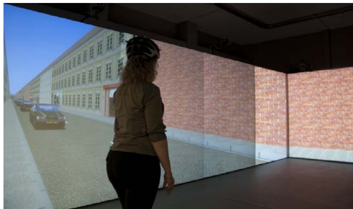
Figure 2 : Rendu visuel du simulateur par système de rétroprojection.
