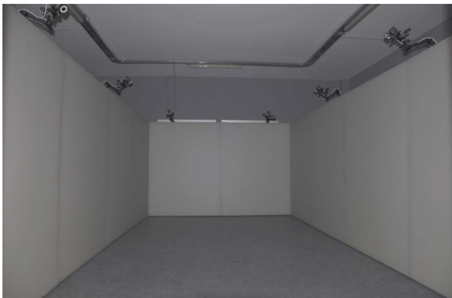
Figure 1 : Configuration en U des écrans du simulateur de traversée de rue et caméras VICON® associées permettant la capture du mouvement du piéton.
