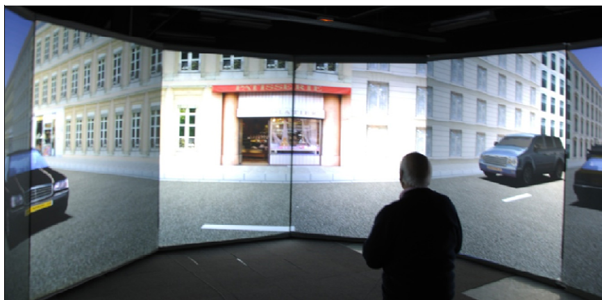
Figure 1: Dispositif de simulation de la traversée de rue pour un trafic à double sens.
