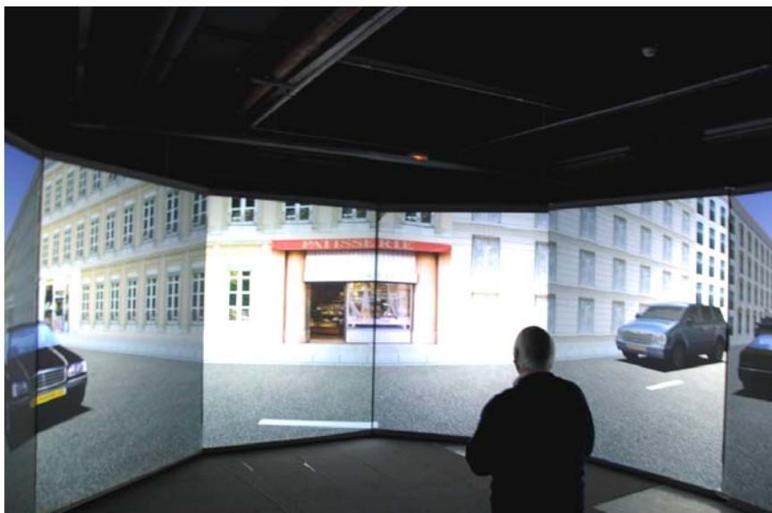
Figure 2 : dispositif de simulation de la traversée de rue pour un trafic à double sens.
