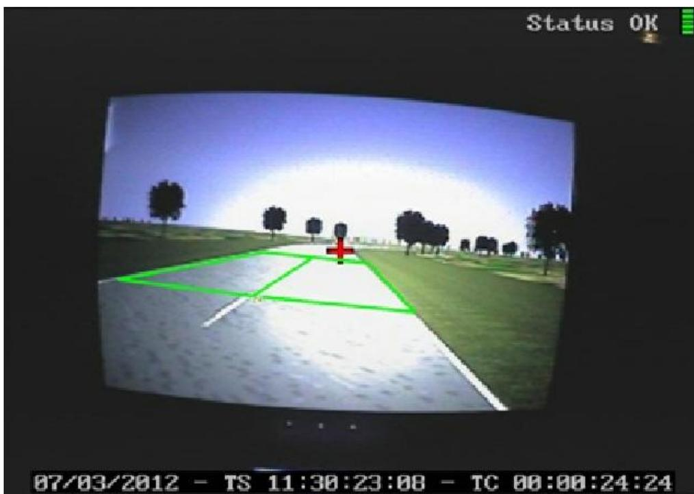
Figure 37 : Illustration du suivi automatique des zones d'intérêt intermédiaires.
