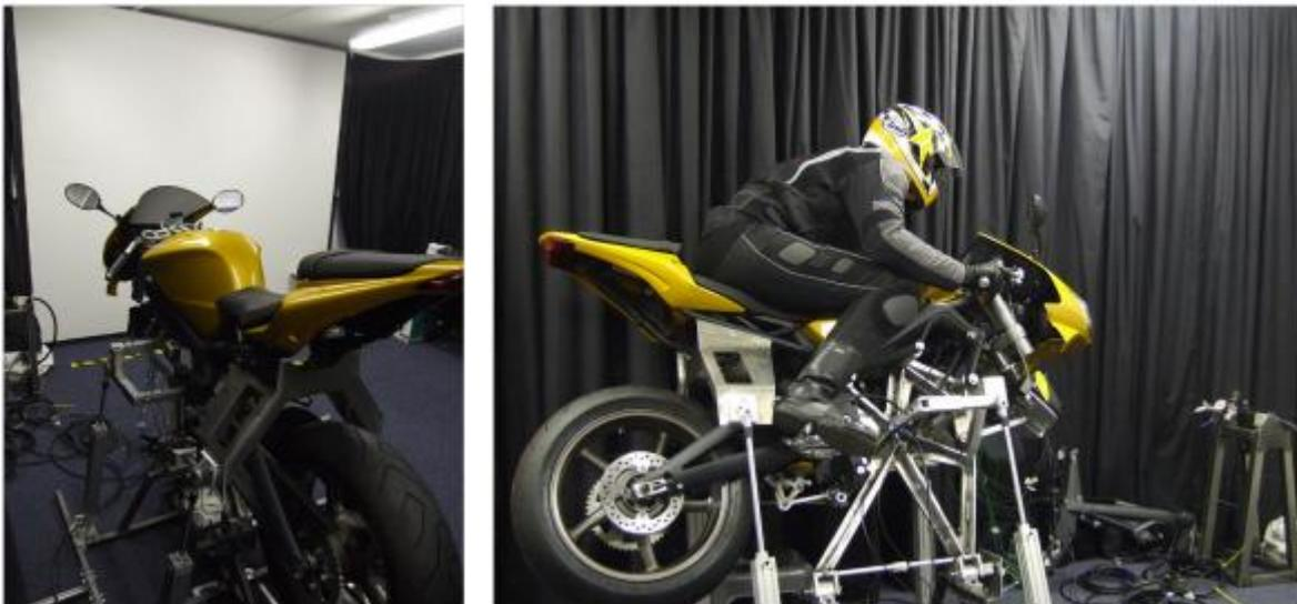
Figure 5 – Architecture du simulateur MotorcycleSim.
