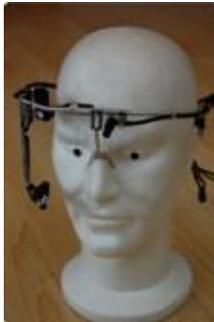
**Figure 35 : Oculomètre Pertech.**
