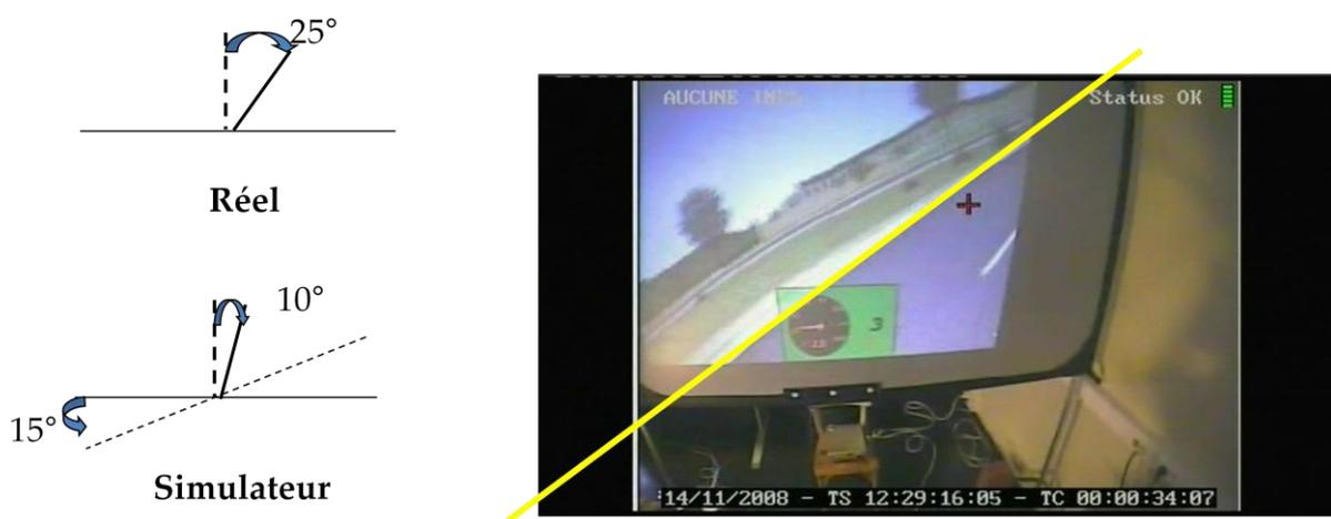
Figure 41 : Illustration de l'inclinaison de la scène visuelle en sens opposé à la direction du virage pour restituer la sensation d'inclinaison en conduite moto sur simulateur.
