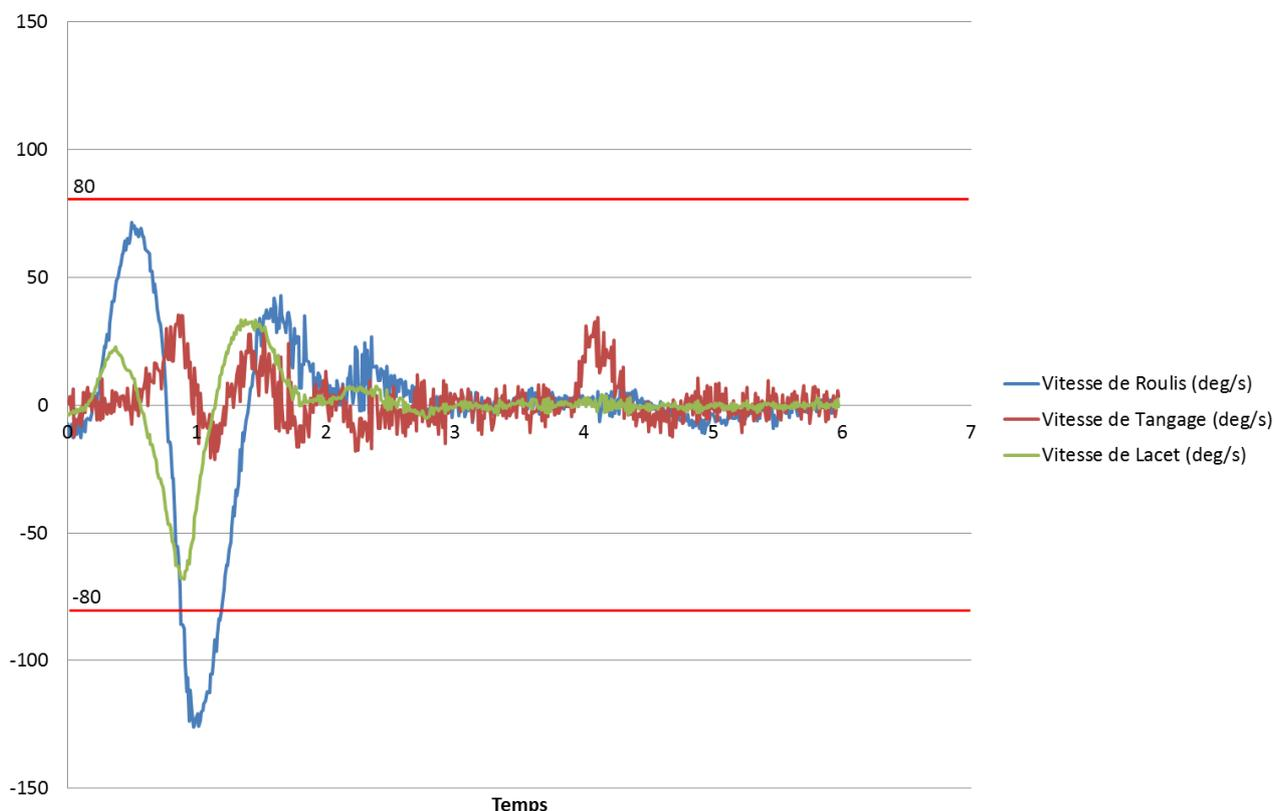
**Figure 15 : Évitement vers la Gauche – 3<sup>ème</sup> Essai à Vitesse Maximale
