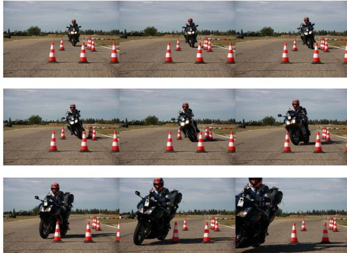
Figure 5 : Séquence photos pour un essai d'évitement à droite
