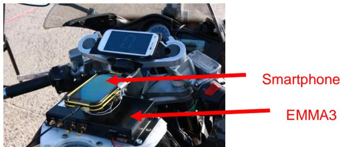
Figure 1 : Montage expérimental permettant de comparer les acquisitions d'un EMMA3 et d'un smartphone
