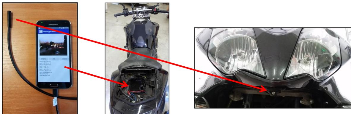
Figure 3 : Installation d'un EMMAPhone et de sa caméra sur une moto
