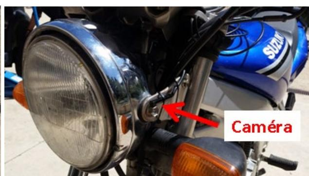
L'installation du système sera réalisée de manière à ce qu'elle soit la plus discrète possible et non destructive. Le smartphone sera installé dans la mesure du possible sous la selle du deux-roues-motorisés ou sous le siège du conducteur pour une voiture. La caméra est miniature (caméra endoscopique). L'installation ne touchera à aucun organe de sécurité ni électronique du véhicule. Seul un branchement à la batterie sera effectué.
