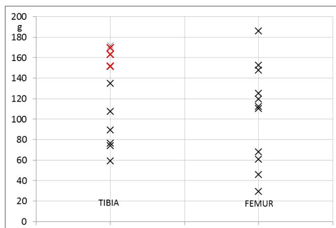
Figure 4 : pics d'accélération à 3ms pour le tibia et le fémur. x : essai avec fracture du tibia
