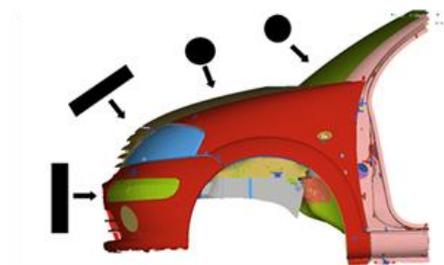
Figure 16 – Impact des corps rigides pour la caractérisation des lois de déformations
