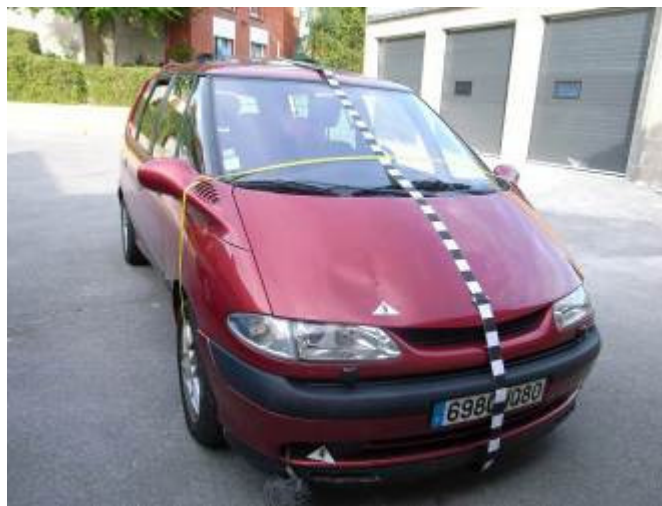
Figure 19 : Vue du véhicule après choc, accident type du scénario 2.
