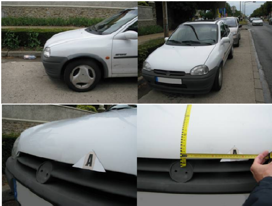
Figure 24 : Points d'impact sur le véhicule de l'accident type du scénario 7.
