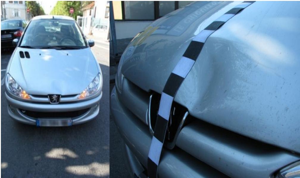
Figure 30 : Points d'impact sur le véhicule de l'accident type du scénario 8.
