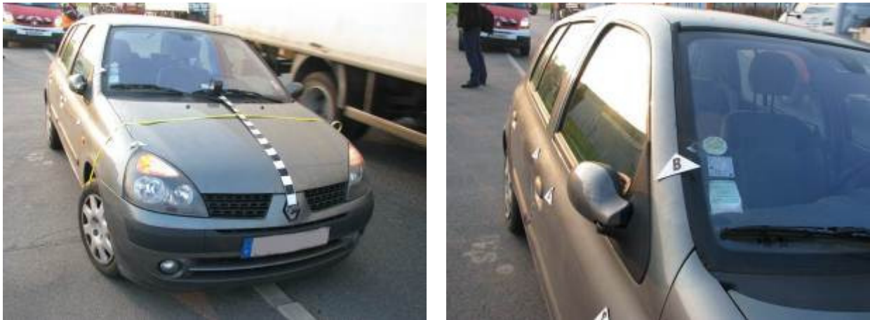
Figure 13 : Points d'impact sur le véhicule de l'accident type pour le scénario 1.
