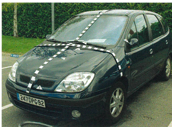
Figure 5: Exemple de quadrillage du véhicule pour relever les points d'impacts
