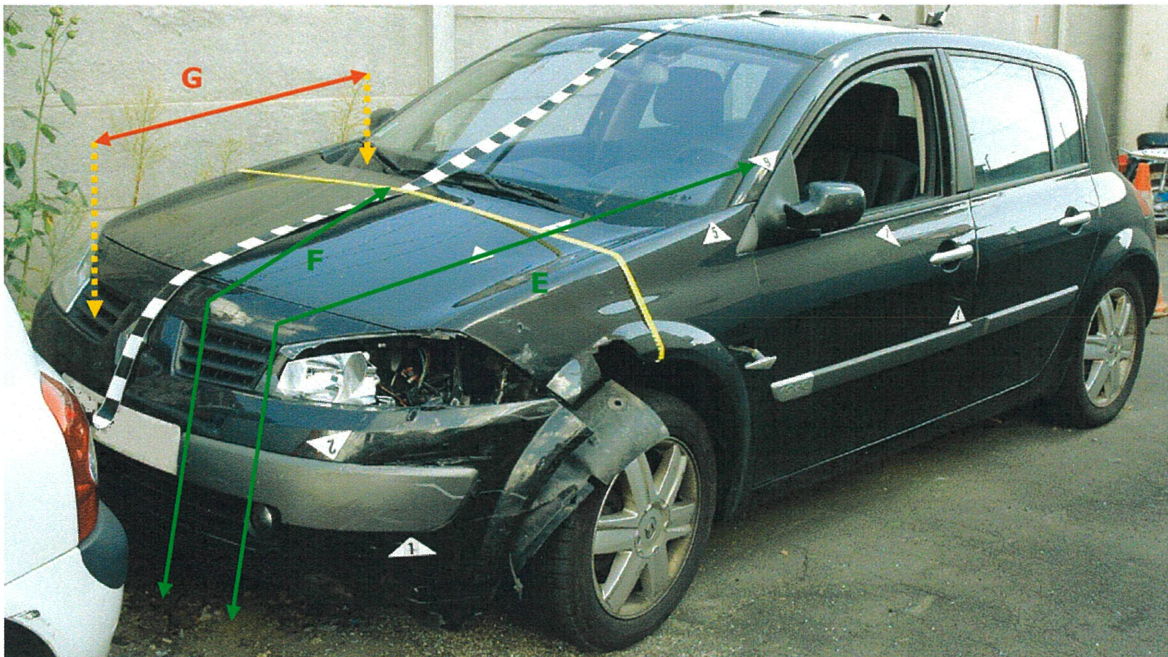
Figure 13: Prises de cotes des distances développées lors d'un choc piéton
